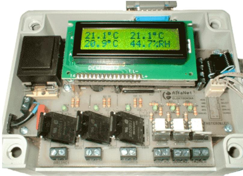
Ovo je verzija regulatora na profesionalnoj štampanoj ploči, koja opto-trijake i trijake (ili releji po potrebi) u svim izlazima (za grijanje 12A/600V i 8A/600V za motor i odvlaž./dovlaž.). Ako su na izlazima releji potrebno je podešiti gornji i donji prag okidanja da bi se spriječilo treperenje releja na graničnoj vrijednosti. Zbog toga je u softveru uvedeno i podešavanje histereze za sva tri grijaca.
